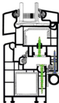
**СФЕРА ПРИМЕНЕНИЯ:** для крепежа фурнитуры и петель в ПВХ профилях. Оконный шуруп для ПВХ – это фурнитурный шуруп высокого технического качества со спиральным острым наконечником, потайной головкой и крестообразным шлицем Phillips (PH) для оптимального использования в производстве оконных профилей из ПВХ.
